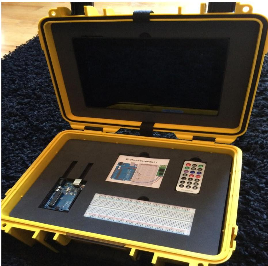
*Abbildung 1: Ausführung des IoT-Koffers incl. Rechneinheit (Variante A). Sämtliche Komponenten befinden sich im Unterteil des Koffers (2. Ebene)*
